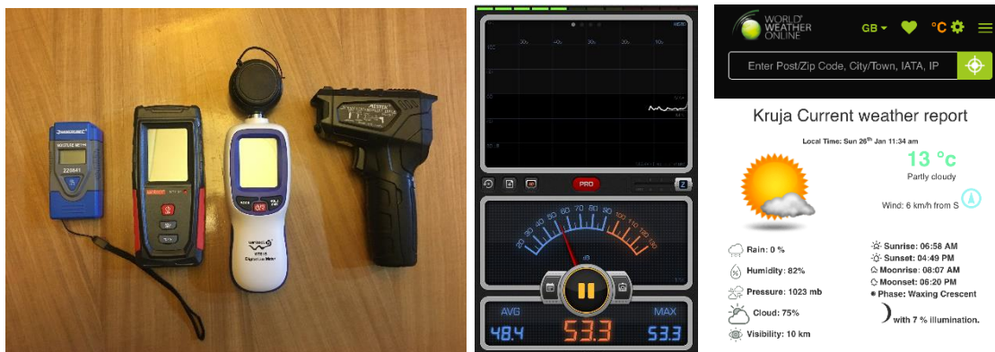
Figura 87. A. Instrumentat matës: matësi i lagështisë, matësi i fushës elektromagnetike, matësi i nivelit të dritës, matësi i temperaturës së mureve B. Aplikacion për matjen e nivelit të zhurmës; C. Karakteristikat e motit në Krujë, datë 26.01.2020
